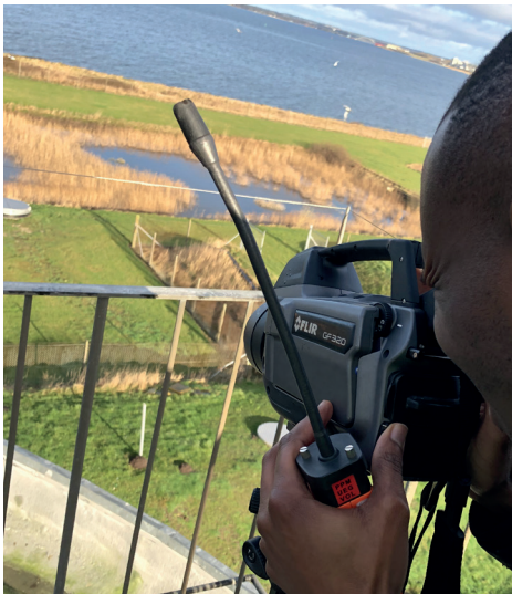
FLIR-kameraet kan vise, hvor der er udslip.
