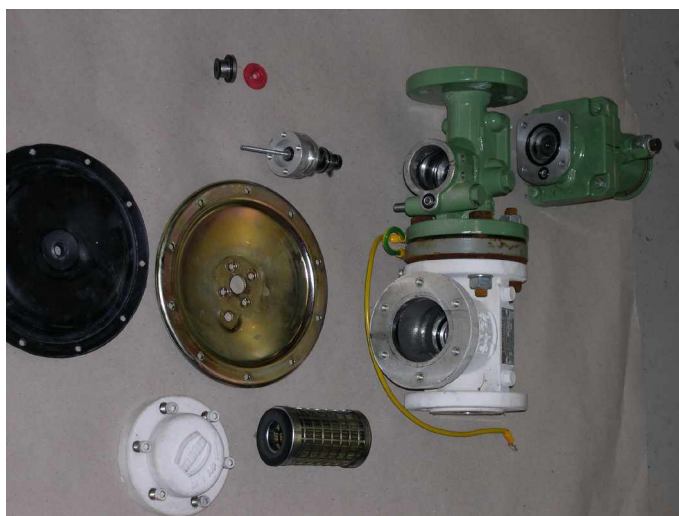
Figur 26 Reduktionsventil og filter (de hvide dele) adskilt efter forsøgsperiodens udløb
