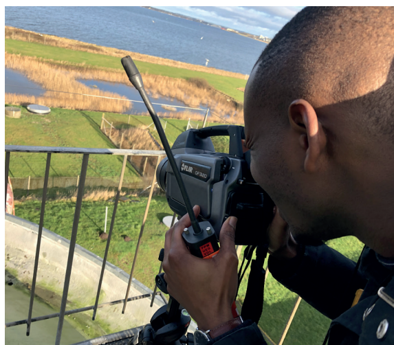
En måletekniker fra DGC er i gang med at screene et biogasanlæg for lækager.
